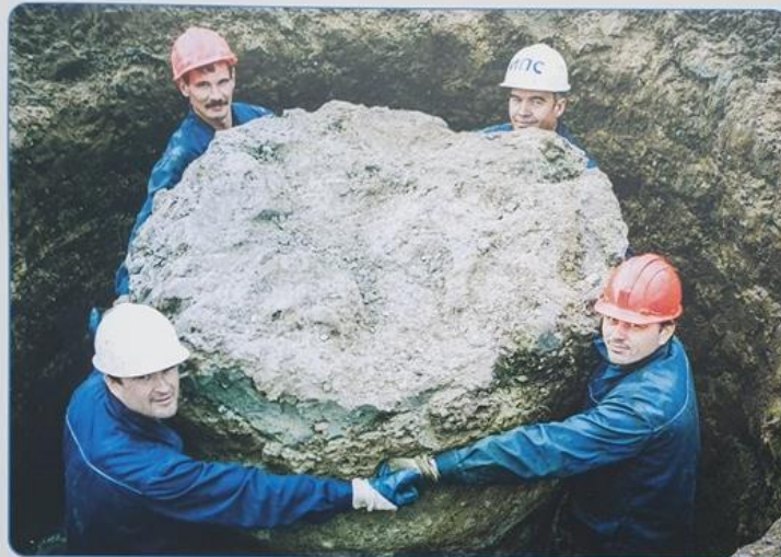
ГРУНТОЦЕМЕНТНАЯ КОЛОННА ЖЕТ 2. ДИАМЕТР 1800 ММ.
